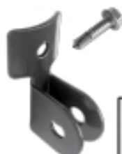
18.131 UCHWYT PODPORY SŁUPKA POJEDYNCZY (OCYNK GALWANICZNY) mocowana na wkręci samogwintujący 6, 3 x 25
